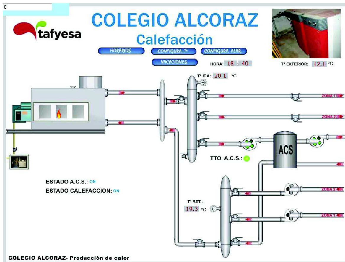
Ilustración 59: Sistema de gestión de la instalación de producción de calor Colegio Alcoraz
